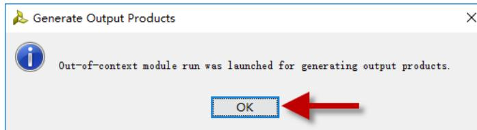
图 3-21 点击 OK 确认 IP 相关文件已生成
