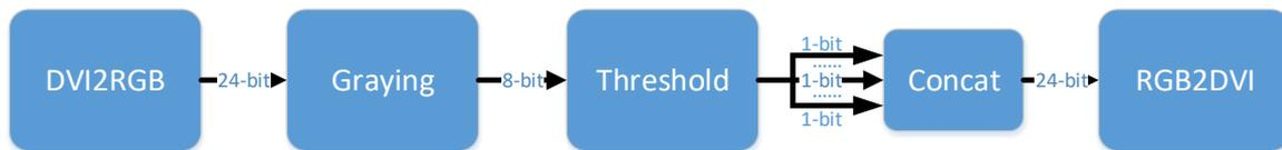
图 1-4 图像二值化连接示意图
